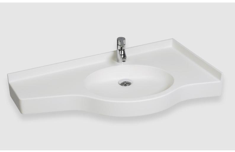
Der Waschtisch MONTREAL wurde speziell für den Einsatz im hochwertigen Betreuungssegment entwickelt. Trotz der kompakten Abmessungen von 1000 x 500/200 mm bietet der Waschtisch großzügige Ablageflächen. Die zweiseitige Wischleiste mit Hohlkehle und die weichen Radien machen die Reinigung zudem einfach und sicher. Die schmale Waschtischseite ist werkseitig mit Seitenteil versehen. Das Modell ist wahlweise als rechte und linke Version erhältlich.
